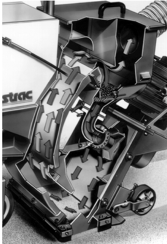
Bild 3.11 (Schematische Darstellung des Strahlmittel - Luftstroms)
