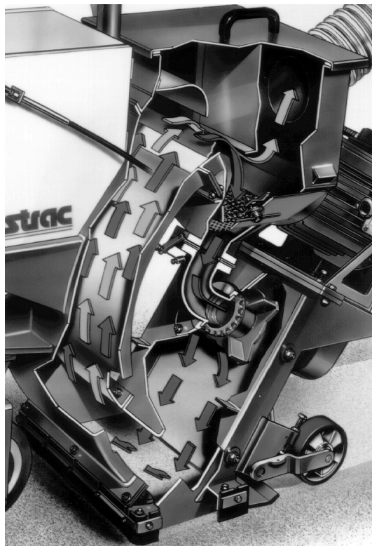
Bild 3.2 (Schematische Darstellung des Strahlmittel - Luftstroms)
